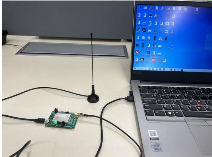
图 4-1 连接示意图
